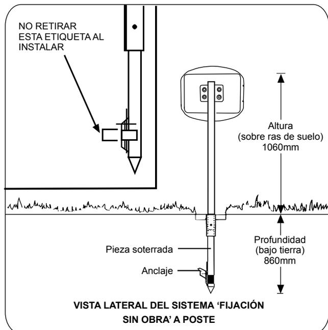
1. Apoye la pica en el terreno en posición vertical y coloque el protector de instalación (Fig. L).
