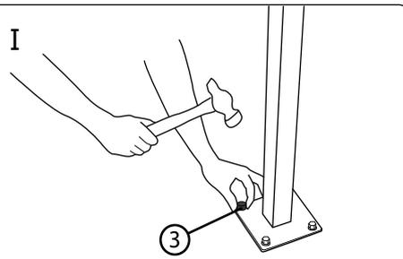
NOTA: Recomendamos que el poste sea instalado sobre cemento. Si va a cementar el lugar de colocación, recomendamos unas dimensiones para el dado de cemento de 400 x 400 x 300mm de profundidad.
