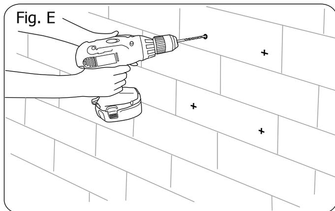
NOTA: Apto para usar en pared de cemento, ladrillo, hormigón o piedra. Cualquier otro tipo de pared requerirá el tipo de fijación apropiado y arandelas de 20mm.
